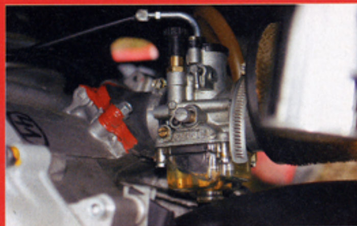
Vergaser mit transparenter Schwimmerkammer
