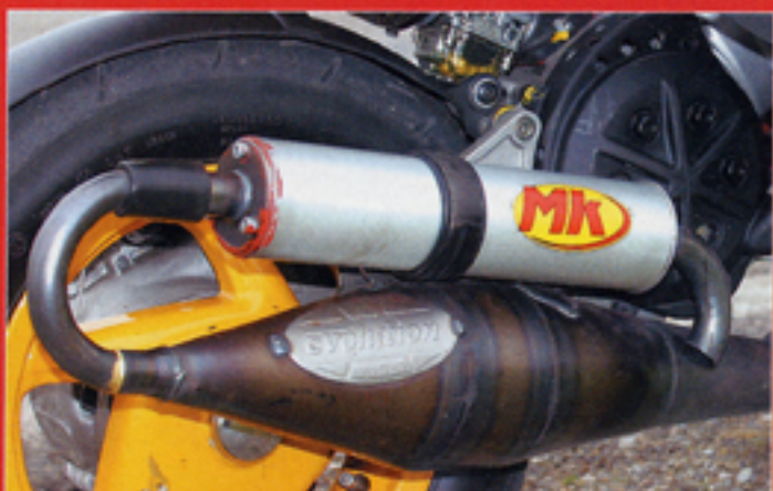
In dieser Birne liegt die Zweitaktkraft
